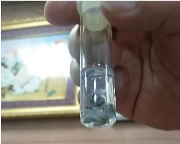
④を傾けても沈降物とコンクリート片が固着しており、流動化しない。
