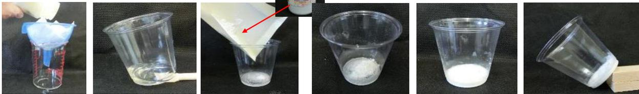
④未反応の原液を濾過 ⑤水酸化カルシウムを投入 ⑤投入直後 ⑤投入攪拌直後 ⑥固化を確認(未反応も含浸材が再度反応)
