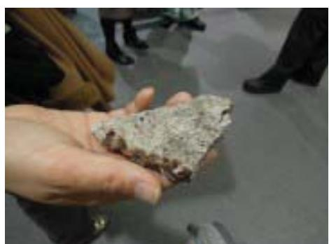
落下したコンクリート片は2個。大きい方は10cm×6cm×3cm、重さ130g。もう一つは30g。高架部分は高さ3m。たまたま救急車の屋根に落ちただけで人身事故にはなりませんでしたが、フロントガラスを直撃したら大惨事になりかねないところでした。コンクリート片は高架橋のジョイント部分のコンクリート製の壁高欄です。継ぎ目に隙間があるのでステンレス製の遮水板で覆われた内側のコンクリが劣化し落下したのです。
